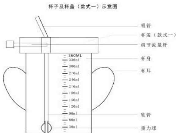
图 3 脑卒中老人流量控速饮水杯示意图
