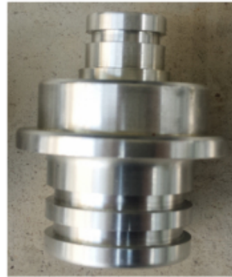
图 28 传动轴加工实物图 - 外部特征
